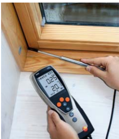
冷気によるすきま風の測定
