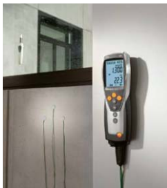
U値プローブと熱電対で壁面U値測定
