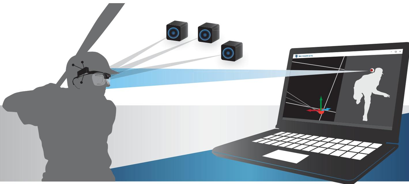
3次元視線解析ソフトウェア「SKYCOM EYE」は、視線計測機\*とモーションキャプチャシステム「OptiTrack」のデータを同時収録し、解析を実現するソフトウェアです。OptiTrackで視線計測機をトラッキングするため、ワールド座標系での3次元的な視線位置を高精度に解析できます。
