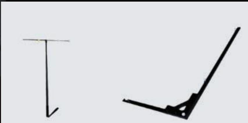
精確に校正された2つのキャリブレーションキットで3次元空間を構築します
