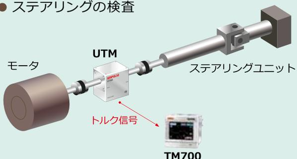
ステアリングなどの自動車部品において、トルクを計測することにより回転のスムーズさを定量化して出荷検査に使用できます。
